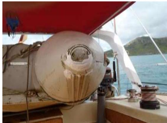
lässt sich der Schaden mit der Klebe und Dichtmasse 5200 FC von 3M wieder beheben, das Zeug ist wirklich Klasse, viel besser als der von der Dingi Herstellerfirma empfohlene PVC Kleber. 24 Stunden später ist das Beiboot wieder betriebsbereit und wir sind froh, denn selbst wenn eine weitere Verklebung sich auflösen wird wissen wir wie sie zu reparieren ist.
